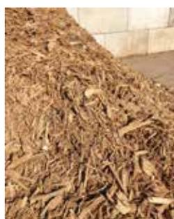
Un tri est réalisé dans les déchets verts réceptionnés à la PAVD afin d'extraire les troncs et branchages de grosses sections. Ces derniers sont broyés, criblés et la production analysée pour fabriquer un paillage normalisé selon le référentiel NFU 44 551. Il est commercialisé auprès des entreprises d'aménagement et d'entretien des espaces verts, 60 t ont ainsi été vendues en 2021.
