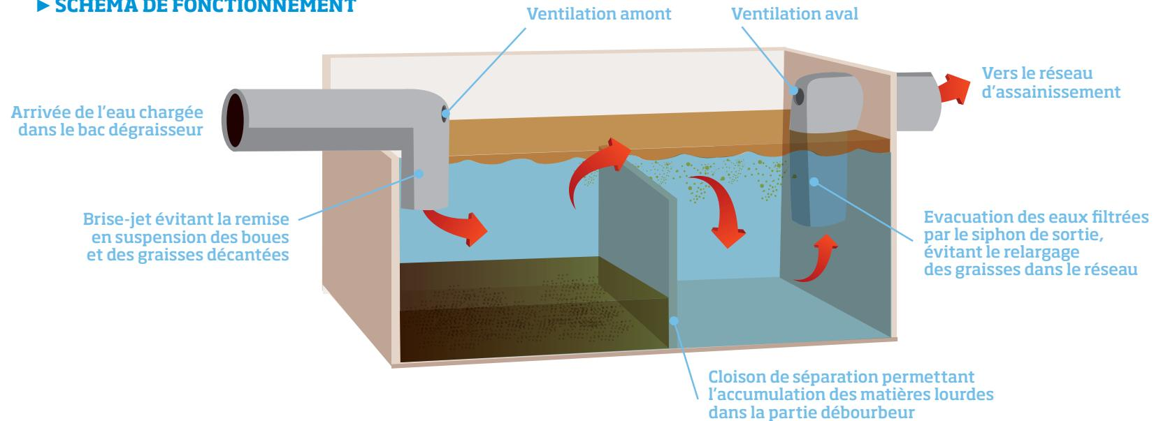
Le bac à graisse doit pré-traiter les eaux provenant des préparations culinaires, des évier, des lave-vaisselles, des siphons de sol, des plonges, des lave-mains...
