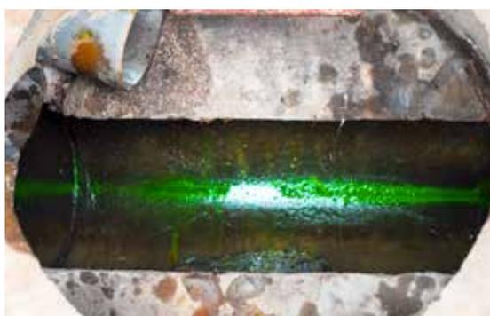
*En mettant un colorant dans les évacuations des habitations, les équipes de Branchements-Conformité vérifient le bon raccordement des habitations au réseau d'assainissement.*
