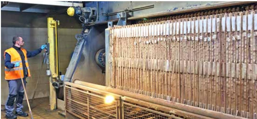
*Pour être transportées plus facilement, les boues sont déshydratées par filtres-presses (photo), par filtres-bandes ou par centrifugeuse.*
