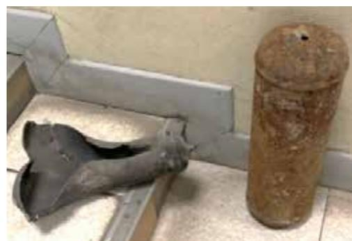
Les bonbonnes, de plus en plus grosses, qui explosent avec la chaleur des fours, provoquent la casse de barreaux de grilles et de briques réfractaires, engendrant des coûts de réparation élevés.
